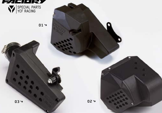
VYSOCE KVALITNÍ KRYT VZDUCHOVÉHO FILTRU 2012-18 (SLOUŽÍ K OCHRANĚ FILTRU PŘI MYTÍ MOTOROKY) AIR FILTER COVER HIGH-RANGE 2012-18 (FOR WASHING THE BIKE)
